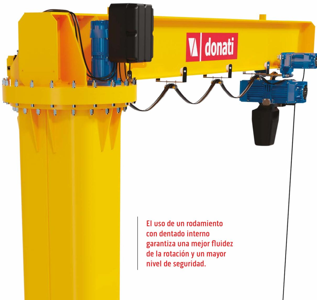
El uso de un rodamiento con dentado interno garantiza una mejor fluidez de la rotación y un mayor nivel de seguridad.
