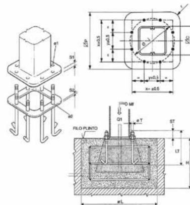
Hinweis: Der Fundamentrahmen mit Ankerschrauben, der in der „Säulenausführung“ für die Befestigung der Konsole an der Fundamentschwellschraube verwendet wird, ist auf Anfrage erhältlich.
