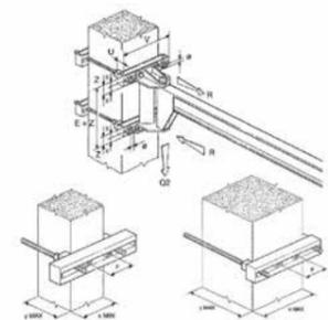
Hinweis: Die Bügel- und Zugstangeneinheit, die in der „Wandausführung“ für die Befestigung der Konsole an einem Pfeiler verwendet wird, ist auf Anfrage erhältlich.
