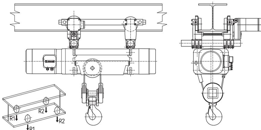
**LAUFKATZE IN EINTRÄGER-BAUWEISE DST/R FÜR ELEKTRISCHE SEILZÜGE DRH - VERSION MIT 2 SEILABGÄNGEN (2/1)**
