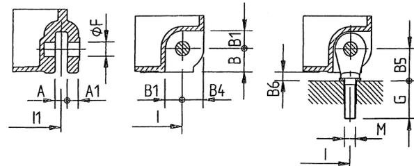
Die universelle Aufhängeöse (2 und 4 Seilabgänge) oder die Auflage-Zugstange (6 und 8 Seilabgänge) werden serienmäßig geliefert. Für die Höhen I und I1 siehe Seite DRH aufliegend/hängend.
