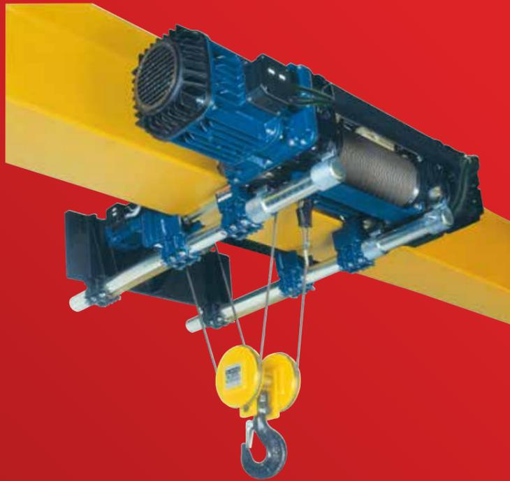
Para asegurar el aprovechamiento máximo de la carrera del gancho y las dimensiones laterales mínimas del cuerpo del polipasto, los componentes base (motor, reductor y tambor) están acoplados entre ellos en línea coaxial, a través de ensambladuras empernadas de alta resistencia.
