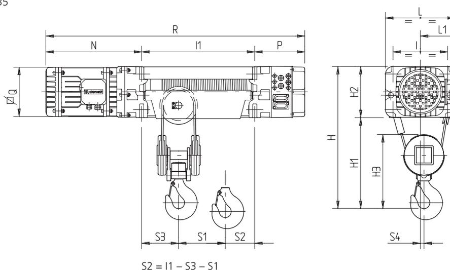
\* Pour DRH3 et DRH4 avec B.T. la cote P devient: DRH3 = 330; DRH4 = 360
