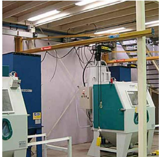
Ausführung lässt sich der in der Höhe verfügbare Raum optimal nutzen, da keine Stangen vorhanden sind, und der Hakenlaufweg maximal genutzt werden kann. Der Arm kann mit angeschobenen, elektrischen und mechanischen Laufkatzen kombiniert werden.
