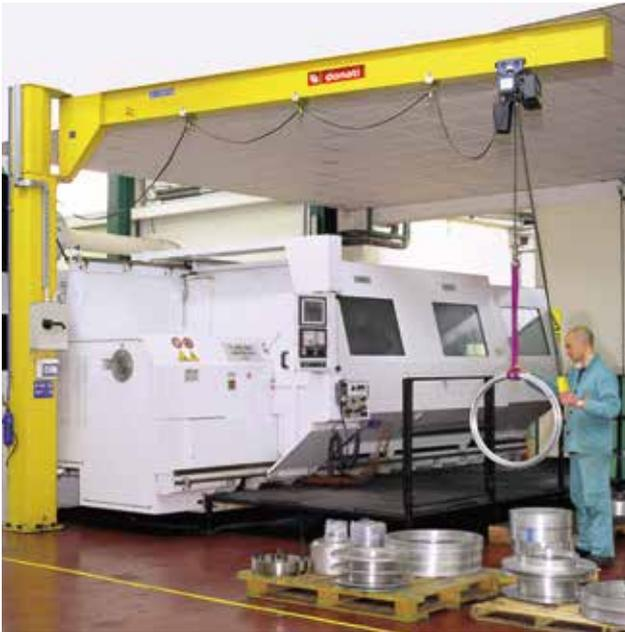
**DIE AUSLEGERKRANE MIT MANUELLER ROTATION, AUSFÜHRUNG A MIT „SÄULE“, BAUREIHE GBA, UND MIT „WANDKONSOLE“, BAUREIHE GBP,** sind für das Handling vor Ort von Waren innerhalb eines Werkes, auf einem Werkhof oder als Steuereinrichtung für Betriebs Arbeitsstationen konzipiert. Sie sind serienmäßig für Traglasten von 125 bis 2.000 kg und Ausladungen von 2 bis 8 m erhältlich. Hergestellt werden sie in den Ausführungen C-T-H je nach den drei unterschiedlichen Armausführungen.
