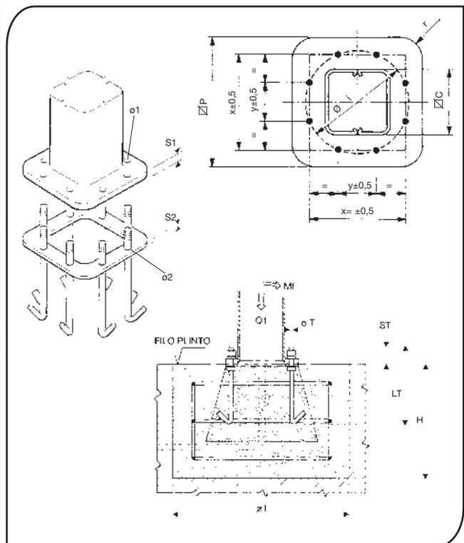
**Contropiastra per fissaggio a pavimento con tasselli chimici delle gru a colonna serie GBA**
