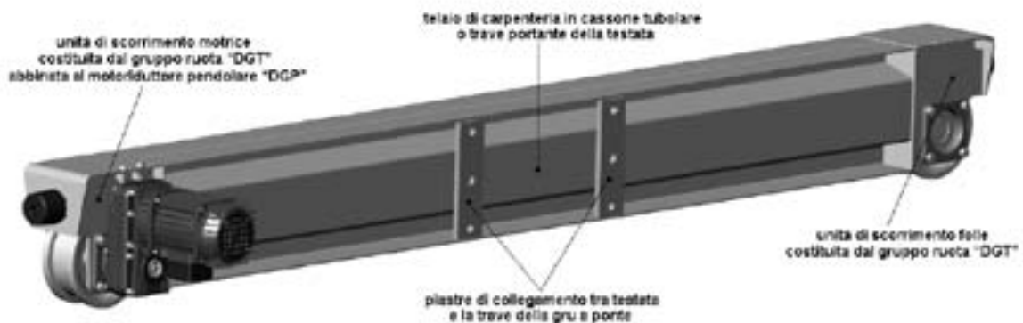
fig. 2a - Testata in esecuzione per gru MONOTRAVE
