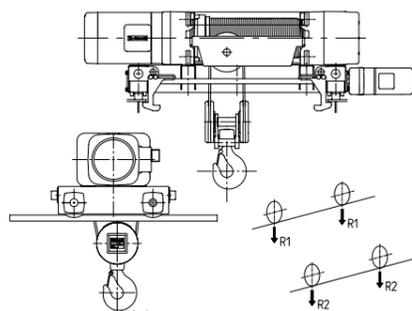
**LAUFKATZEN IN ZWEITRÄGER-BAUWEISE DRT FÜR ELEKTRISCHE SEILZÜGE DRH - VERSION MIT 6 SEILABGÄNGEN (6/1) UND 8 SEILABGÄNGEN (8/1)**
