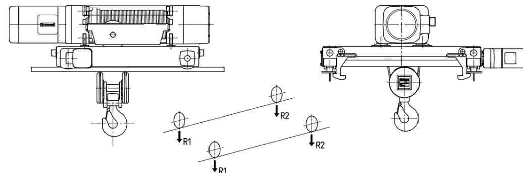
**LAUFKATZEN IN ZWEITRÄGER-BAUWEISE DRT FÜR ELEKTRISCHE SEILZÜGE DRH - VERSION MIT QUERFÜHRUNG MIT 2 SEILABGÄNGEN (2/1) UND 4 SEILABGÄNGEN (4/1)**
