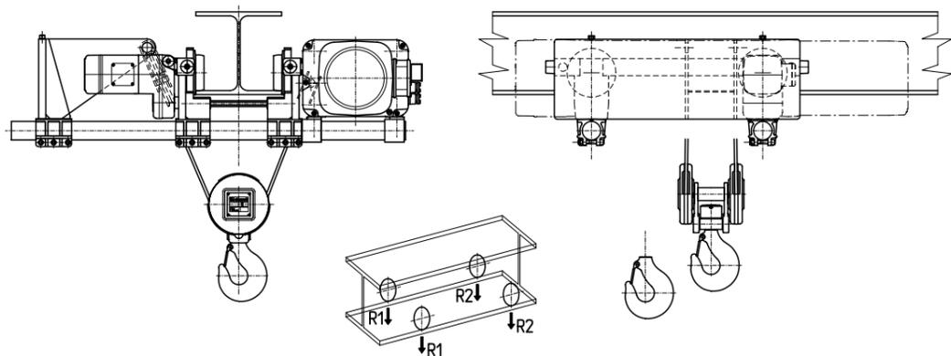
LAUFKATZEN IN ZWEITRÄGER-BAUWEISE DRT FÜR ELEKTRISCHE SEILZÜGE DRH - AUFLIEGEND/HÄNGEND - VERSION MIT 2 SEILABGÄNGEN (2/1) UND 4 SEILABGÄNGEN (4/1)
