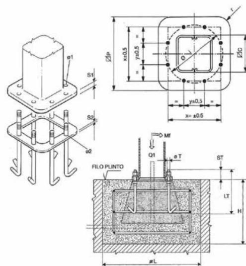
Nota: La cornice di fondazione con tirafondi, utilizzata nella versione a "Colonna" per il fissaggio della colonna stessa al plinto di fondazione viene fornita a richiesta.
