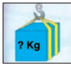
Controllare il peso del carico. Non sovraccaricare i tiranti.
